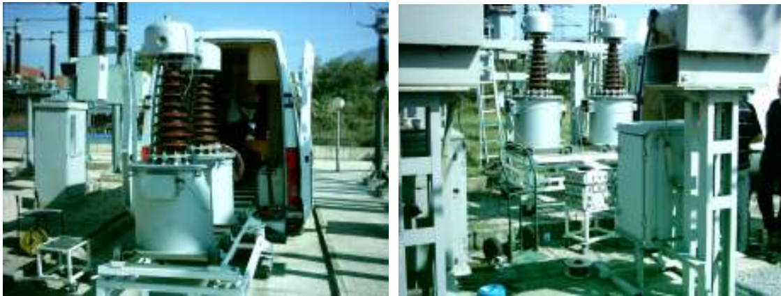
Slika 1. Pokretna Laboratorija za ispitivanje mernih transformatora na terenu
